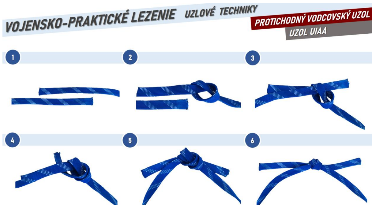
Obr. 9 Vodcovský uzol – pichaný, uzol UIAA na spájanie plochých slučiek (zdroj: vlastné spracovanie)
