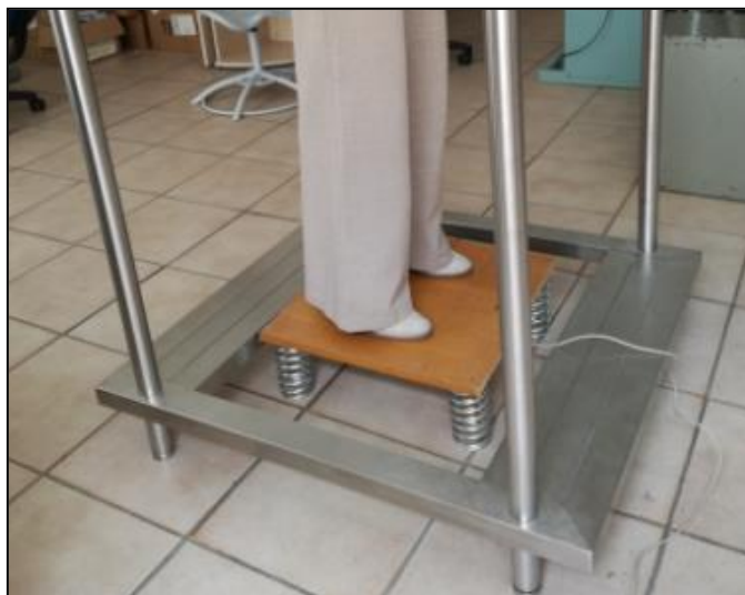
Obr. 1. Labilný stabilografický systém FiTRO Angle Sway Check (Fitronic, Slovakia)
